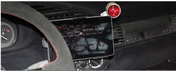
Fig 4m - Nexus7 surfplatta och aktiv hållare monterad i BMW med LS2 motor.
